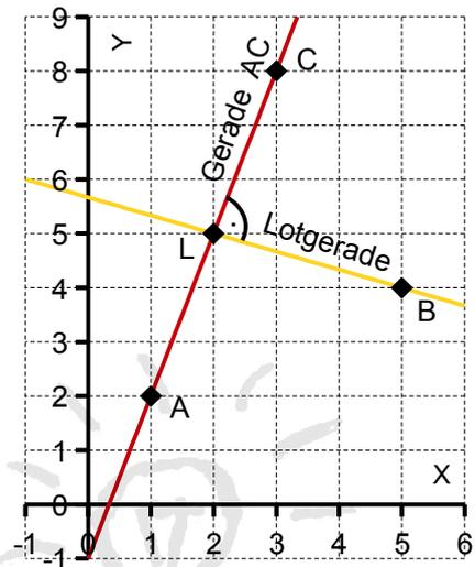
d) Berechnung des Schnittpunktes L der beiden Geraden:
